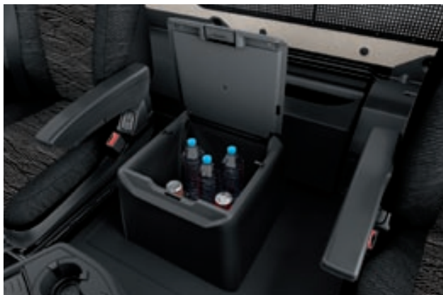
Casier haut sur le tunnel moteur. Pour ranger facilement les cabines dotées d'un tunnel moteur, ce dernier peut être équipé en option d'un casier haut comprenant une poubelle intégrée et un couvercle. Ce casier de 15 l peut également accueillir une glacière.
