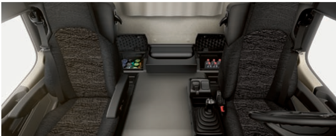
Equipements de la cabine moyenne ClassicSpace. A bord de la cabine moyenne ClassicSpace, deux casiers à couvercle implantés derrière les sièges permettent de ranger tout ce dont on peut avoir besoin sur un chantier. Le casier côté conducteur est également accessible de l'extérieur. Les rangements ménagés dans les parois latérales droite et gauche offrent des possibilités supplémentaires. La tringle fixée de série sur la paroi arrière de la cabine peut accueillir vestes et imperméables. En option, le tunnel moteur peut recevoir un siège central pour un deuxième passager, ou des vide-poches pratiques.
