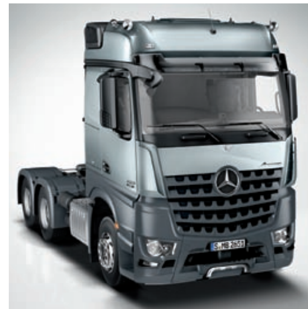
Cabine longue BigSpace. Avec son plancher plat, sa hauteur intérieure de 1,99 m et ses 2 500 mm de largeur, la cabine longue BigSpace offre une grande liberté de mouvement et de nombreux rangements. Elle convient particulièrement aux missions de plus d'une journée.
