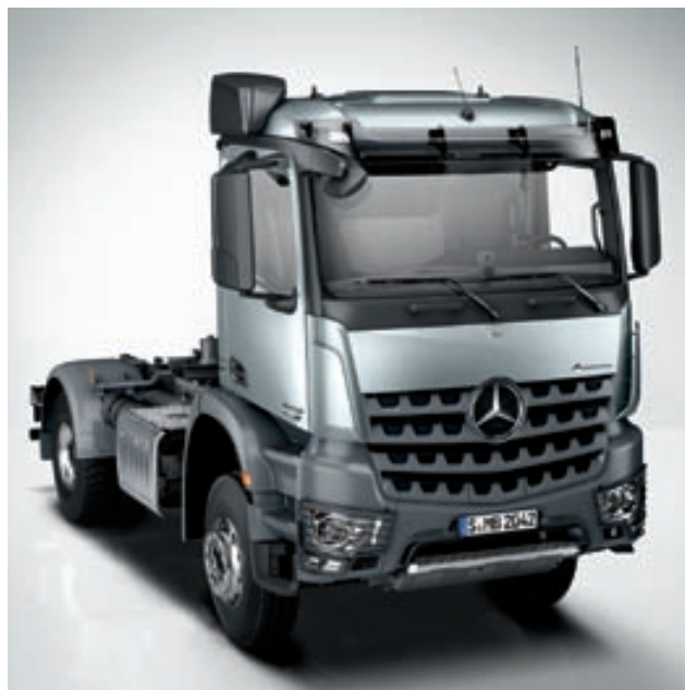
Cabine courte ClassicSpace. Mesurant 2 300 mm de largeur, la cabine courte ClassicSpace peut être équipée d'un tunnel moteur de 170 ou 320 mm de haut. Elle offre un poste de travail pratique et confortable ainsi qu'un accès aisé à plusieurs marches, une excellente visibilité et une parfaite adéquation avec les missions de l'Arocs.
